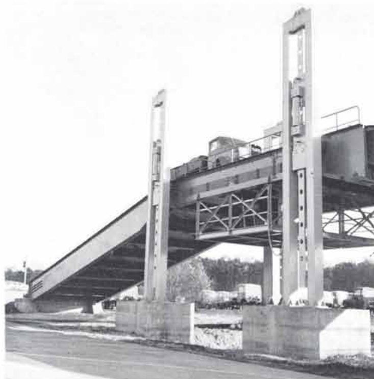
Bild 2: Teilansicht der Lkw-Versuchsrampe mit Hilfsbühne für Hydroaggregat und Portalen mit Kletterhubzylindern.
